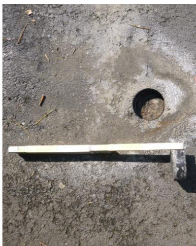
SCHÉMA č.9: Skladba vrstev vozovky na mostě v místě SK1 – na mostě
