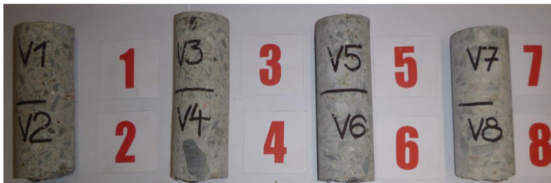
FOTO č.3.1: Dokumentace vývrtů pro destruktivní zkoušky pevnosti v tlaku betonu NK
